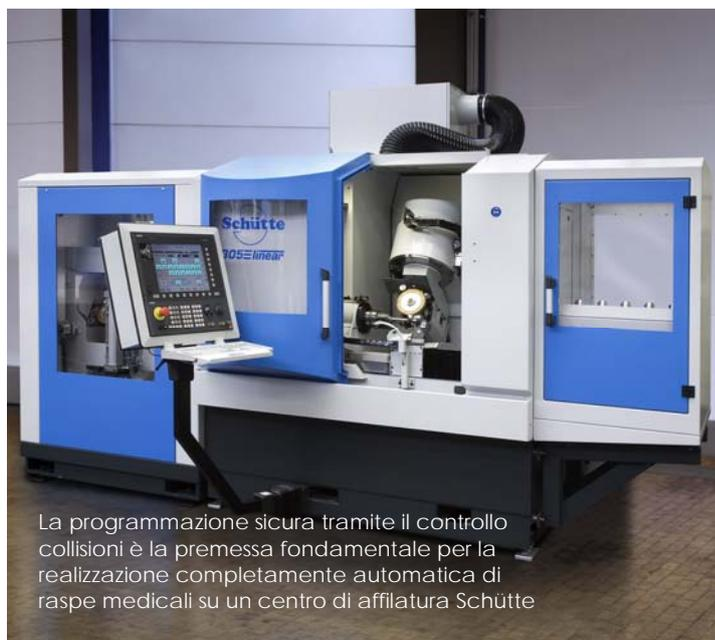
La programmazione sicura tramite il controllo collisioni è la premessa fondamentale per la realizzazione completamente automatica di raspe medicali su un centro di affilatura Schütte
