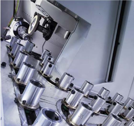
Magazzino dei particolari grezzi e finiti
